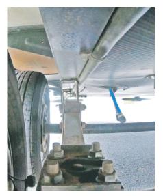
**FACTORY GAP BEFORE** TRAILER SUMOSPRING INSTALLATION
